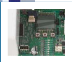
Puerto USB para actualizaciones e intercambio de datos de configuración.
